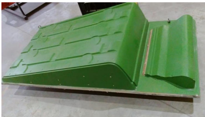
Рабочая форма из композитного материала (полиэфирные смолы и фанера)
